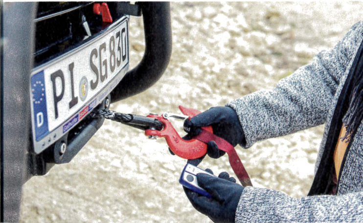
Komfortabel: Die Horntools-Seilwinde lässt sich per Fernbedienung steuern. Ein Unterbrecher macht die Winde stromlos.
