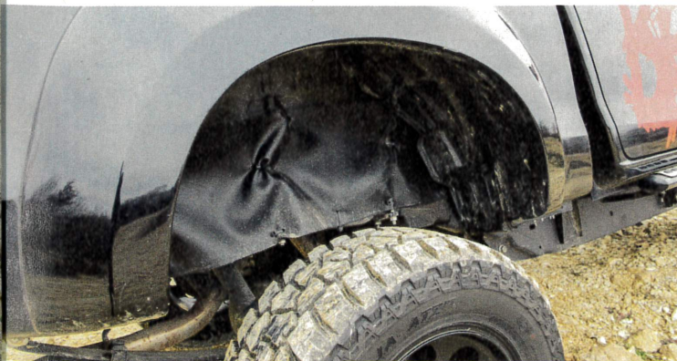
Abgedeckt: Durch den Bodylift entsteht viel Raum zwischen Rahmen und Karosserie. Die robuste Plane sorgt dafür, dass sich möglichst wenig Dreck verteilt.
