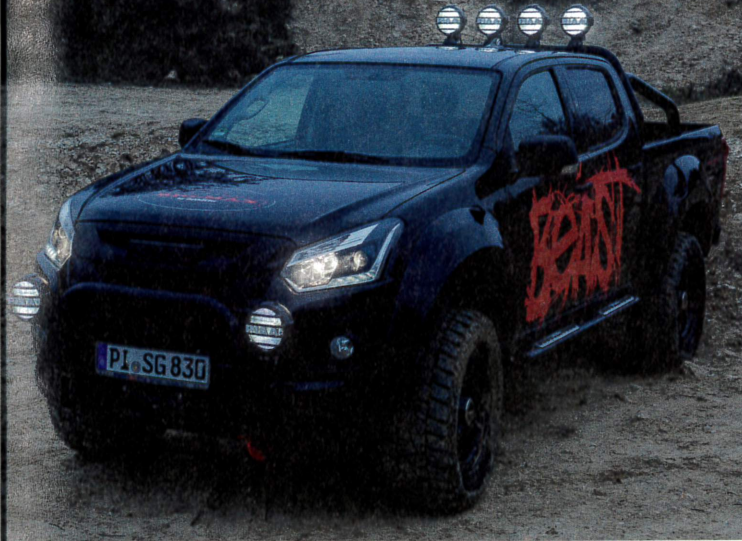
Mehr Licht: Die oberen Zusatzscheinwerfer sind als Arbeitsscheinwerfer montiert. Sie werden per Knopfdruck dem Fernlicht zugeschaltet.
